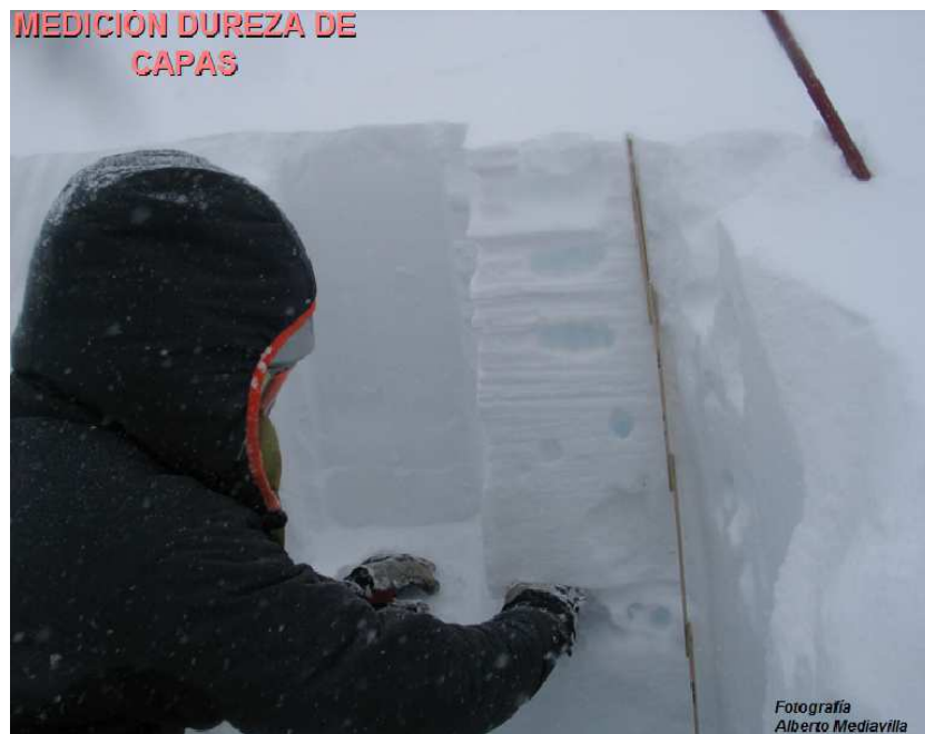
Fig. 31. Medida de durezas de las capas. Fotografía Alberto Mediavilla.
