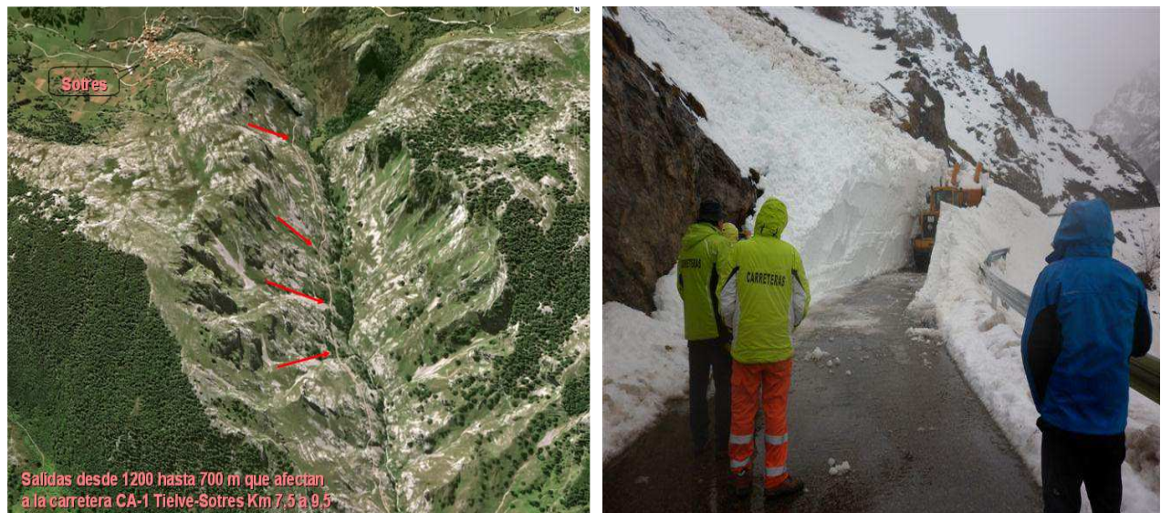
Fig. 43 Aludes de nieve reciente que se producen en los episodios de nieve en cotas bajas. Afectan a la CA-1 entre Poncebos y Sotres (Asturias). Imagen Google Earth.
